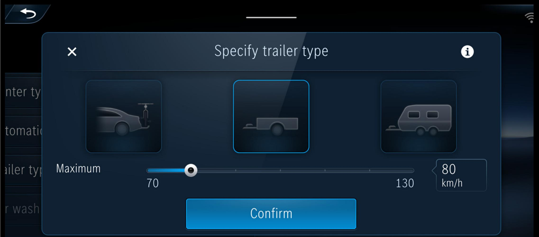
The new Mercedes-AMG GLE 와 The new Mercedes-AMG GLE Coupé 에는 ESP® 트레일러 안정화 기능을 포함한 트레일러 커플링이 옵션으로 제공되어 차체에 트레일러를 장착할 수 있습니다. ESP® 트레일러 안정화 기능은 위급한 상황에 자동 개입하며, 65km/h 이상으로 주행 시 갑작스러운 흔들림을 감지하면 각각의 휠에 제동을 걸어 진동을 줄입니다. 또한, 필요한 경우 엔진 토크를 줄이고 4개 휠에 브레이크를 걸어 차량의 속도까지 낮춥니다.
