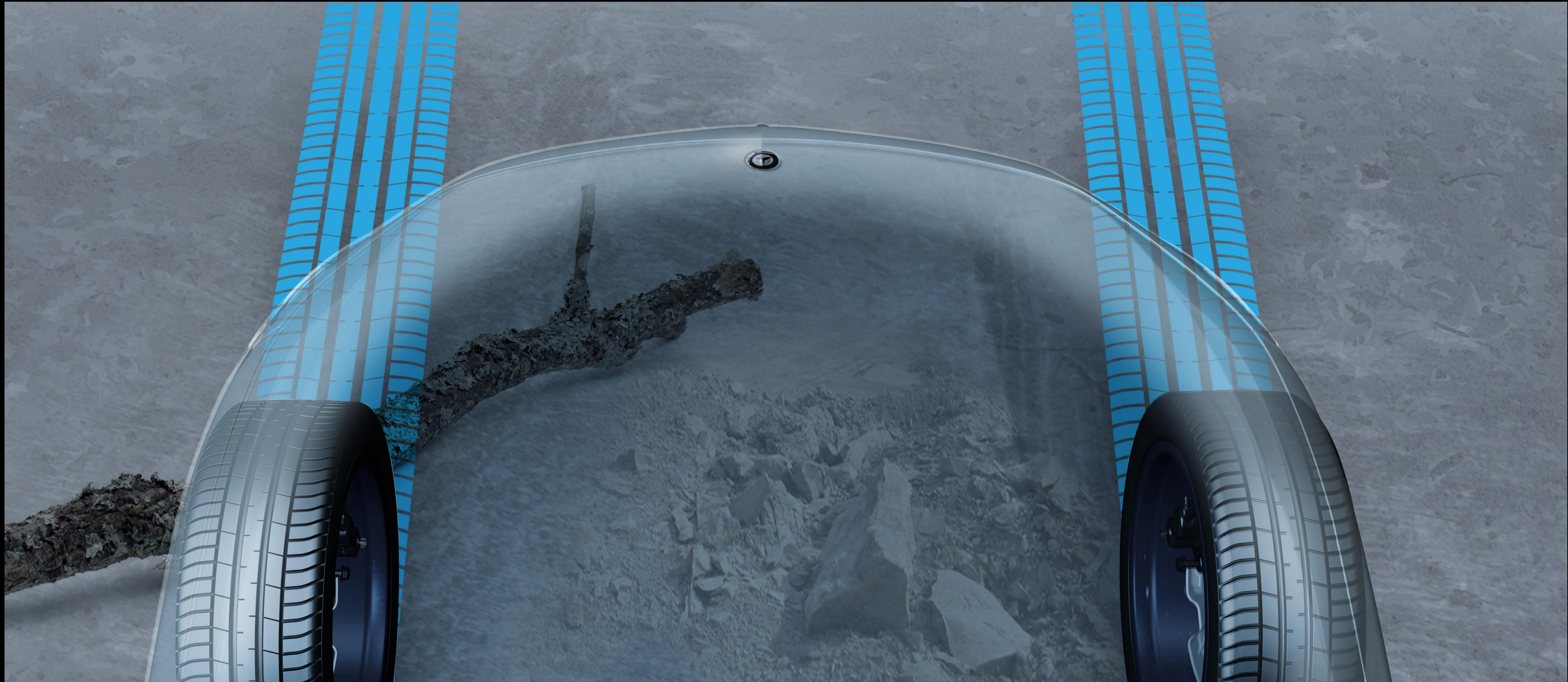
투명 보닛을 통해 역동적인 드라이빙의 즐거움을 더해보세요. 오프로드 모드 활성화 시  $360^{\circ}$  카메라와 연계하여 중앙 디스플레이에 앞바퀴와 조향 위치를 포함한 차량 전면 아래의 실시간 가상 뷰를 제공합니다. 이를 통해 운전자는 경로에 있는 큰 돌이나 깊은 웜푹 패인 곳과 같은 장애물을 조기에 인식할 수 있으며 최적의 주행 경로를 선택할 수 있습니다.
