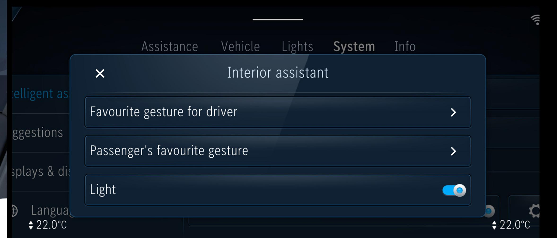
MBUX 인테리어 어시스턴트는 오버헤드 컨트롤 패널에 장착된 3D 카메라 시스템을 통해 운전자를 비롯한 앞좌석 탑승자의 움직임을 분석하여 그에 맞는 기능을 제공합니다. 손과 팔의 움직임, 손이 다가오는 시점을 식별하여 빠른 기능 액세스를 통해 운전자 및 조수석 동승자가 서치라이트 및 다양한 기능들을 쉽게 이용할 수 있도록 도와줍니다. 또한, MBUX 스크린을 직접 터치하지 않고도 미리 설정한 손동작을 취하는 것만으로 MBUX의 즐겨찾기를 불러올 수 있으며, 독서등, 라디오 및 미디어, 지도 내비게이션, 액티브 파킹 어시스트, 시트 조정 등을 간편하게 컨트롤할 수 있습니다. (기본사양)
